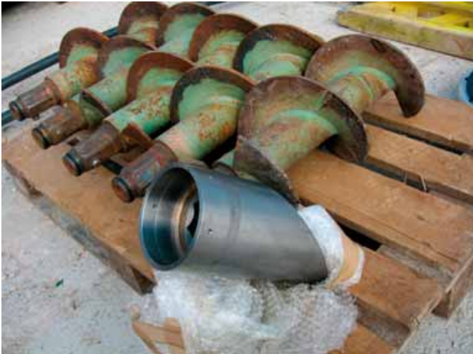
Die Bohrspitze wird am Schluss des Pilotierens über eine Sollbruchstelle vom Außengestänge abgesprengt und verbleibt im Erdreich.
